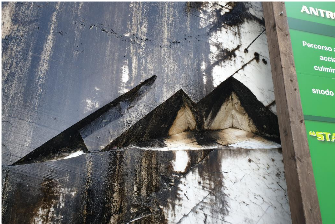
Cunei formati dall'intersezione delle principali famiglie di discontinuità.
