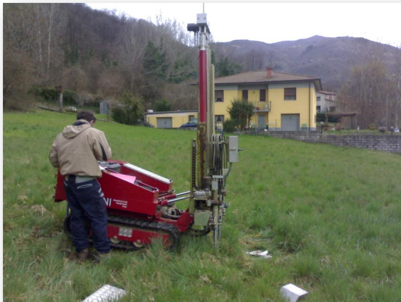
Figura 1 – Prova penetrometrica dinamica superpesante P1
