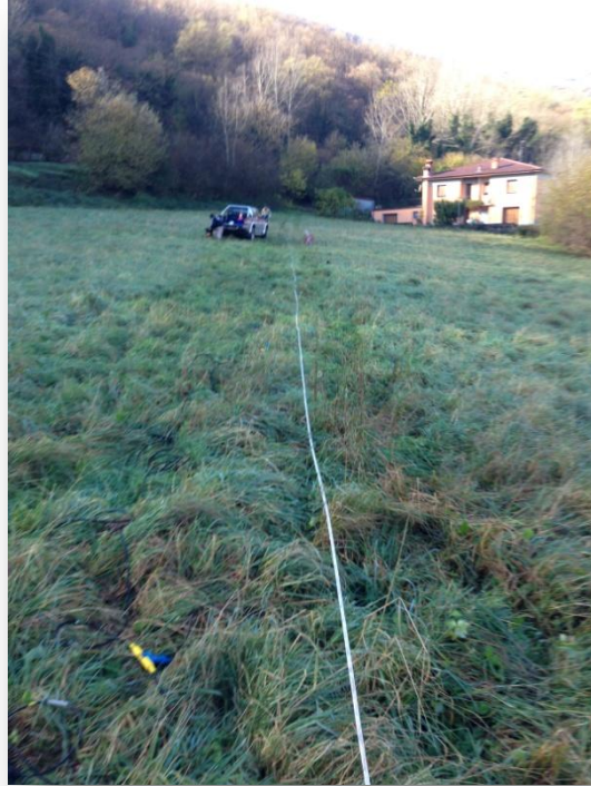
Figura 5 – Stendimento sismico ST2 – onde P
