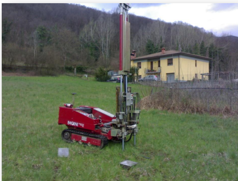
Figura 2 – Prova penetrometrica dinamica superpesante P2
