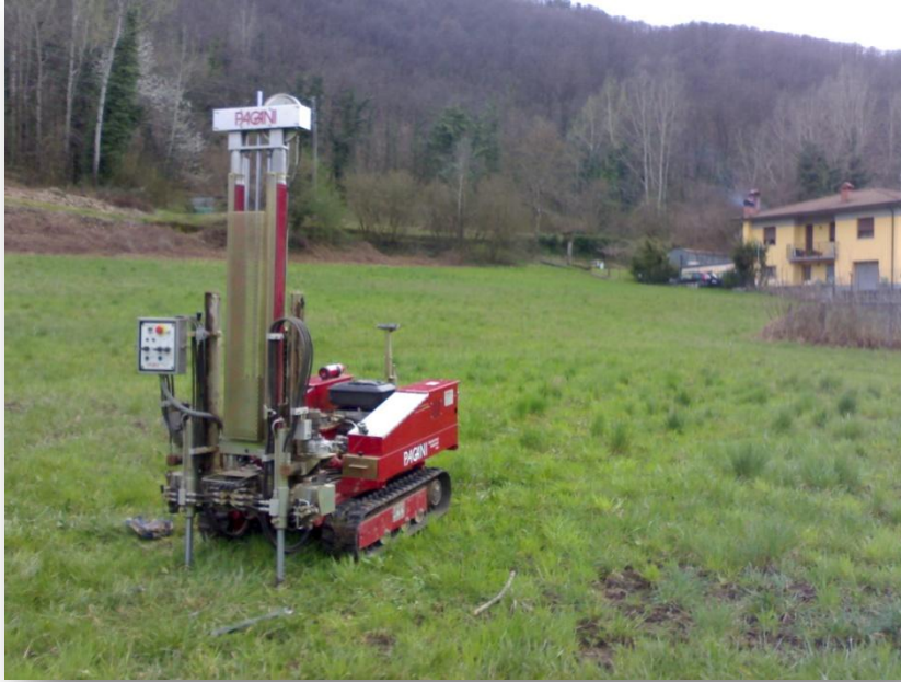
Figura 3 – Prova penetrometrica dinamica superpesante P3
