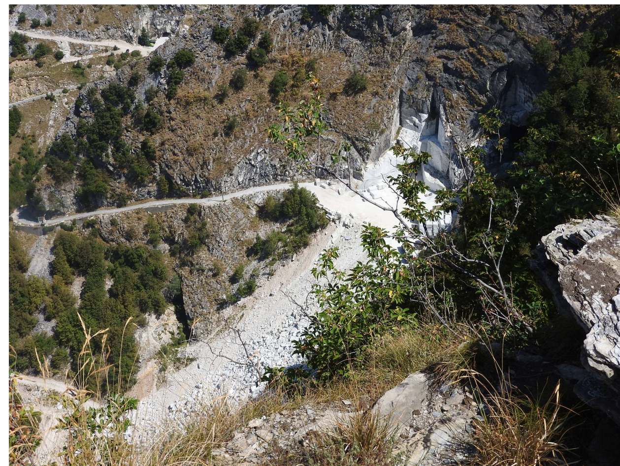
30 - Bacino Borra Larga strada di accesso, ravaneto e fronte cava
